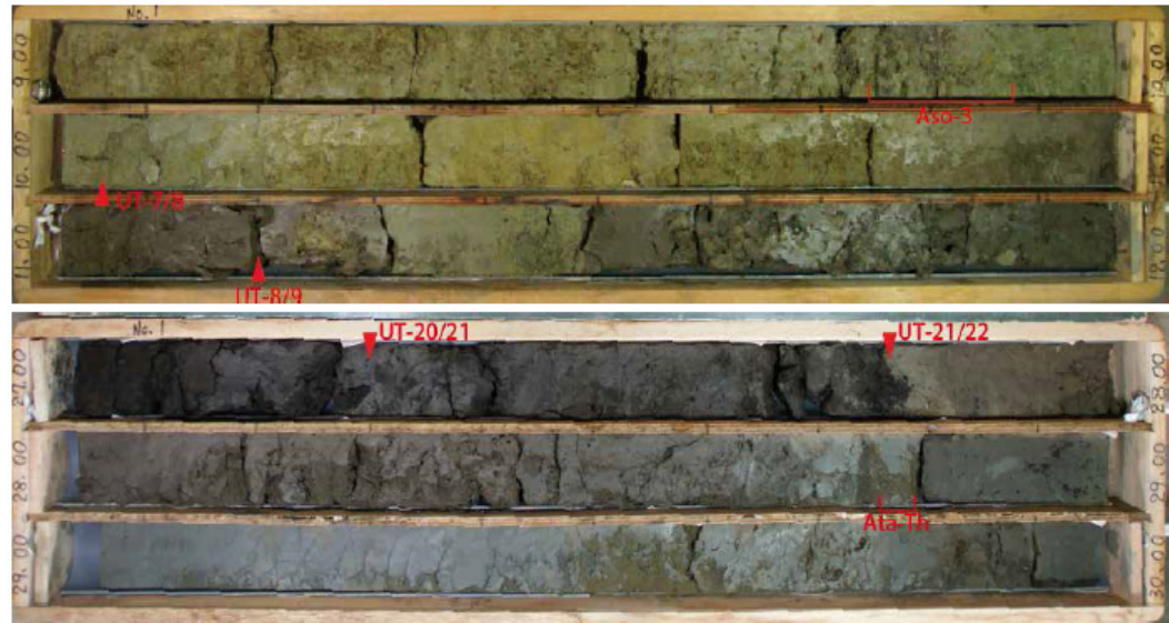
写真3 ボーリングコア写真。上：UT-7/8 境界, UT-8/9 境界および阿蘇3 (Aso-3) が認められる。下：UT-20/21 境界, UT-21/22 境界および阿多鳥浜 (Ata-Th) が認められる。撮影：柳田 誠。
